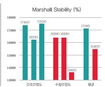
▲ 건조공시체(GS 1, 2, 3)의 경우 기준값인 4.9kN 이상을 모두 만족하였다. 60도에서 48시간 수침후의 잔류안정도비 시험 결과 90%로 기준값인 75%이상 만족하였다. 즉 수분에 대한 저항성 및 견고성(Integrity)이 충분하다.
