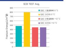
▲ 동결융해처리를 통하여 확인한 수분에 대한 파괴저항성 비율은 평균 75%로 균열에 대한 인성(toughness) 및 견고성(Integrity)이 충분한것으로 판단된다.
