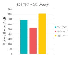
▲ 저온에서의 파괴에너지(Fracture Energy)는 GSC바인더가 개질A, 개질B 보다 동등 혹은 높게 나타났다. 이는 개질에 의해 균열에 의한 저항성 개선으로 균열이 급작스럽게 생기지 않고 지연되어 발생한다.
